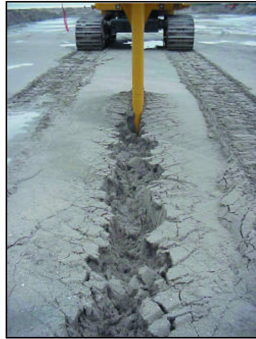
Schémas 5 et 6 - Machine BeauDrain avec détail de la charrue
