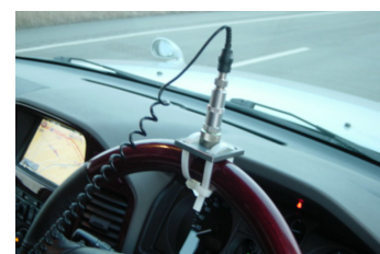
Photo n°2 Le capteur de vibromètre fixé au volant
