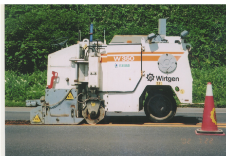
Photo n°1 Engin de fraisage
