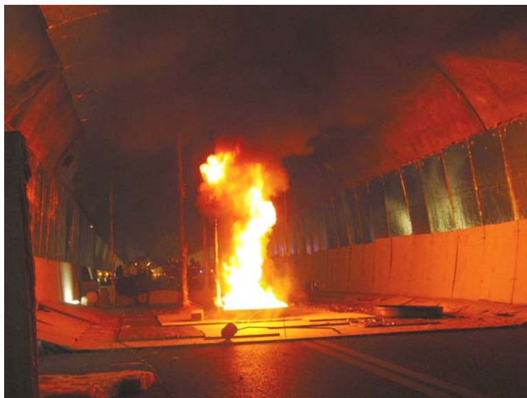
Figure 2 – Image d'un feu de 1,4 MW à l'issue de la phase transitoire. La stratification et l'extension longitudinale des fumées sont contrôlées
