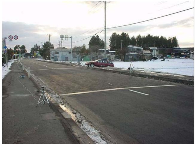
Figure 11 – Equipements pour la mesure du bruit
