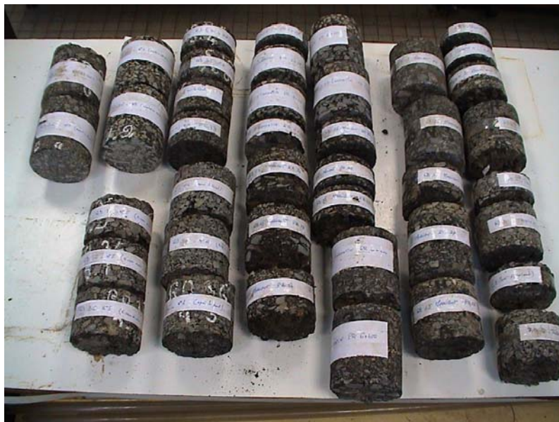
Figure 2 – Carottes de chaussée prélevées sur place
