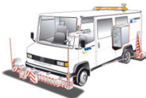
Figure 1 – Exemple d'équipement multifonction pour l'auscultation des caractéristiques de l'état de surface
